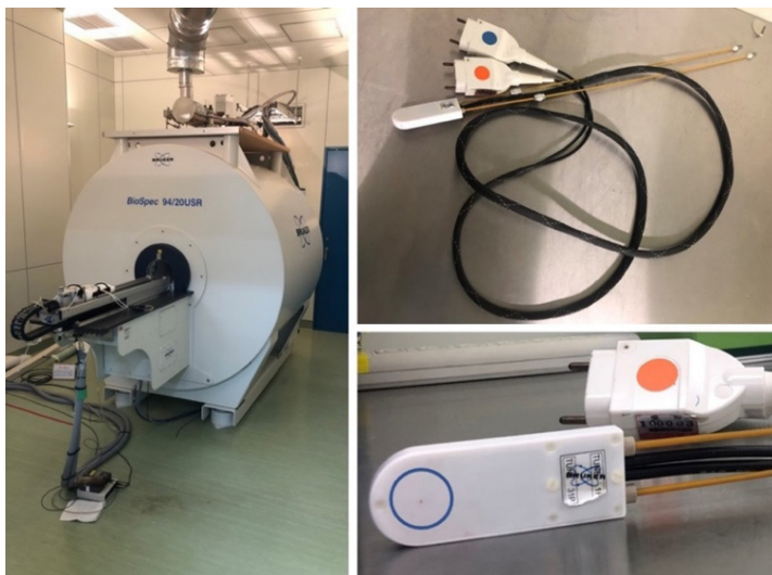
Hình 3. H + /P31 transmit-receive surface coil của máy CHT Bruker 9.4 Tesla.
