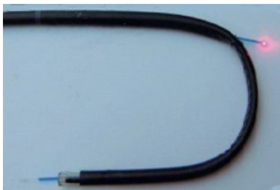
Hình 5A, B. Dây laser gây thủng ống soi mềm
