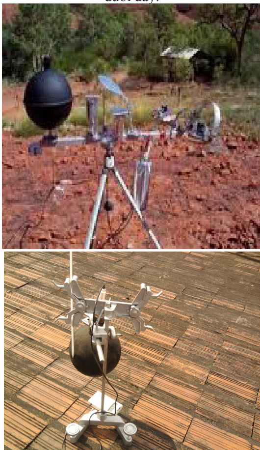
Hình 1. Hệ đo nhiệt tam cầu trên cầu kế Vernon [4], [5]
